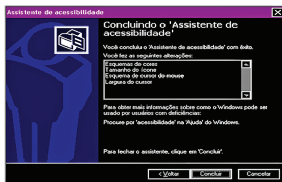
Figura 6 - Exemplos de telas do Assistente de Acessibilidade. Três imagens contendo os três últimos passos na configuração do Assistente de Acessibilidade. Na primeira, escolhe-se o tamanho e o padrão do cursor, na segunda, a taxa de intermitência e largura do cursor e a última mostra a lista das alterações efetuadas. Como no passo anterior foi demonstrada a modificação para a opção "preto em alto contraste", estas três telas já se apresentam neste formato de cores.
